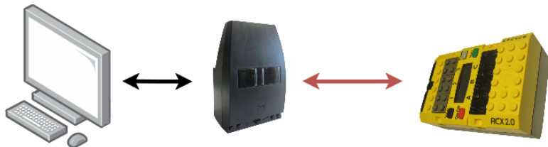
Abbildung: Computer „spricht“ mit RCX über IR Tower
