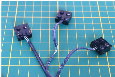
(a) Defekte Verbindungskabel
